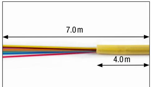
Faserbündel einführen und 7.0m aus Rohr stehen lassen, davon 3m absetzen
