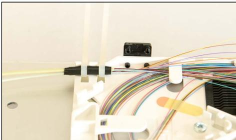
Faserbündel mit Vulkan- oder Isolierband umwickelt auf Spleisskassetten mit 2 Kabelbinder befestigen
