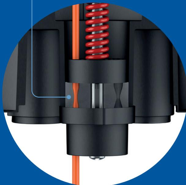
Federdrucksystem sorgt für permanente Vorspannung
