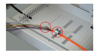
4.Zum besseren Einschieben der Bündeladern in den Flexschlauch kann in die Bündeladern eine Handelsübliche Stecknadel eingesteckt werden.
