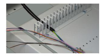
6.Wellschlauch in "Rohrbelegung hinten" (direkt am Mixer) einrasten
