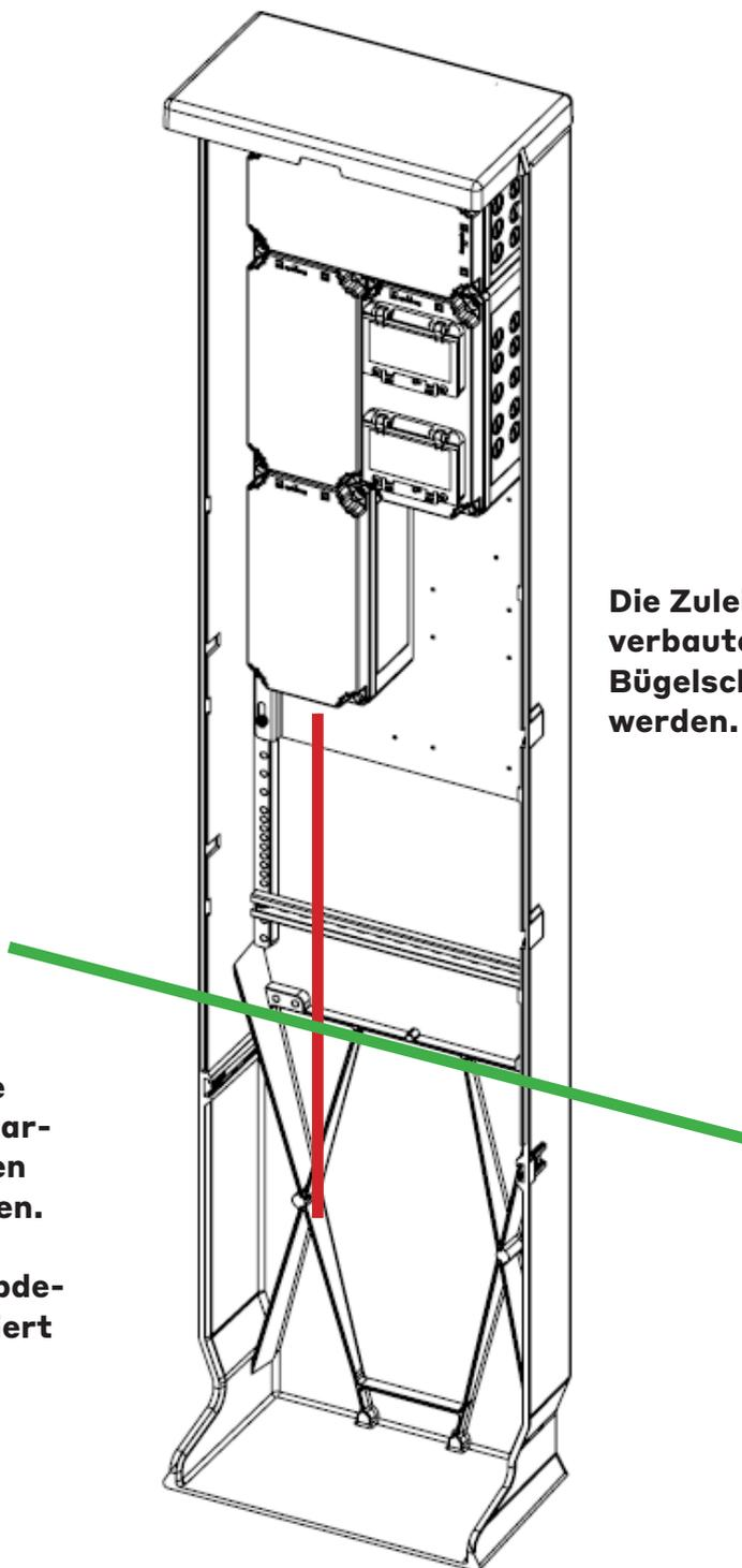
**Die Energieverteilersäule muss bis zur seitlichen Markierung am Gehäuse in den Boden eingegraben werden.**
